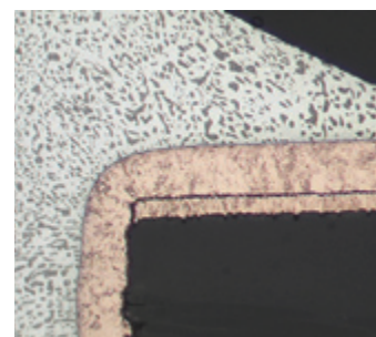
4. ábra PCB lap előkészítése, Z irányú anyagleválasztás méréssel
