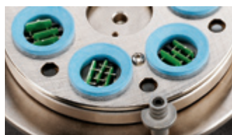
2. ábra PWB kuponok beágyazása
