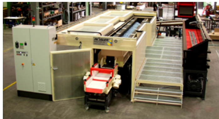
Ezt a vályús koptatót, nagy hatékonyságú hangnyelző rendszerrel felszerelten, a repülőgép test szerkezeti elemei felületének koptatására és tisztítására tervezték.
